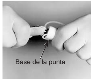
2. Gire en el sentido de las agujas del reloj mientras empuja la base de la punta
